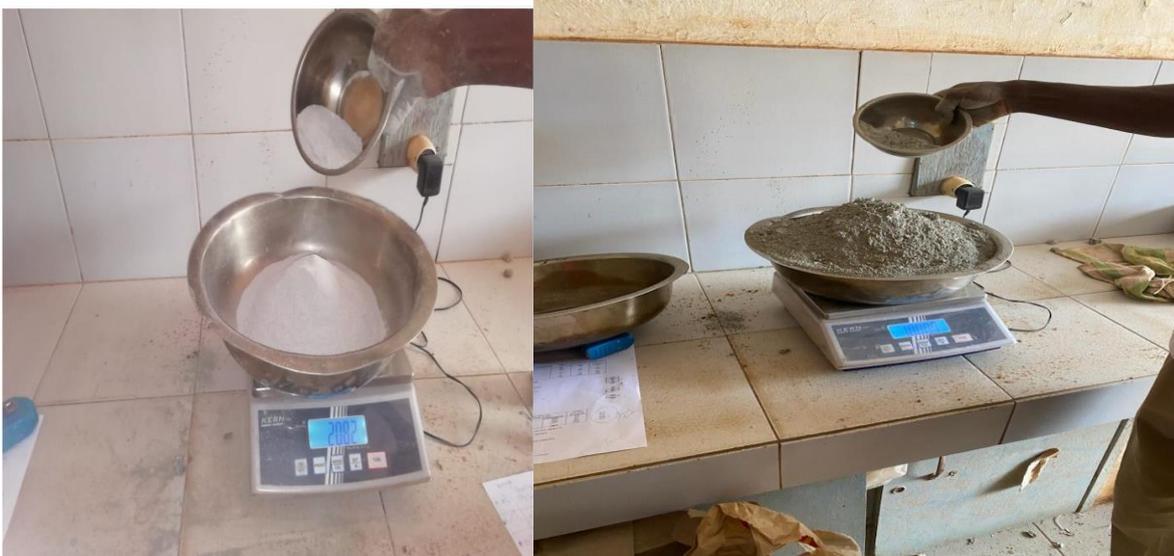
Figure 1: mesure de la masse du verre Figure 2: Mesure de la masse du ciment
