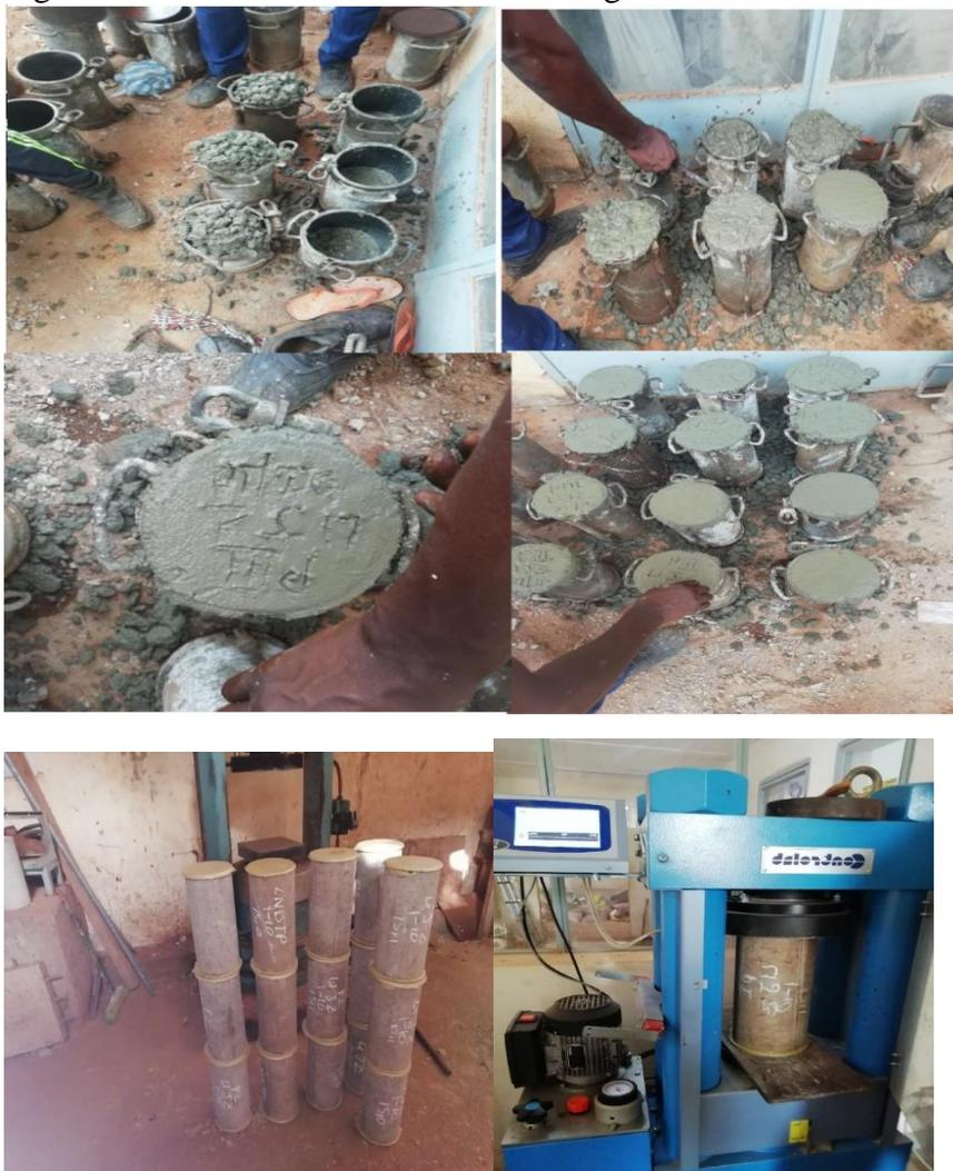
Figure 3: Photos du déroulement de la compression
